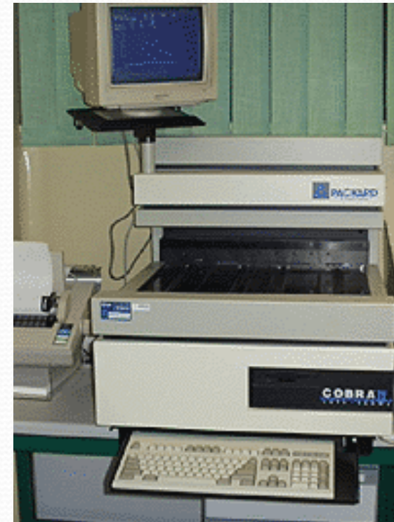
Lector de RIA equipado con 5 detectores de centelleo de INa(Tl). Gran capacidad de muestras (hasta 300 viales convencionales de 10 x 50 mm). Rango de Energía de 15 a 2000 KeV con preselección para ^{125}\text{I} , ^{57}\text{Co} y ^{51}\text{Cr} . Eficacia > 74% para ^{125}\text{I} . (Univ. de León)
