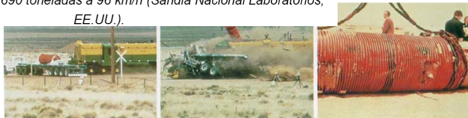
Ensayo de choque de una locomotora contra un transporte a 131 km/h (Sandia Nacional Laboratorios, EE.UU.).
