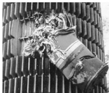
Estado final tras el ensayo de choque de un proyectil cilíndrico a velocidad cercana a la del sonido (300 m/s) contra un embalaje (Lange y otros, 2003).
